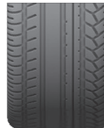
Slijtage bij de juiste bandenspanning
