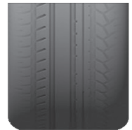
Slijtage bij te zachte bandenspanning
