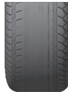
Slijtage bij te hoge bandenspanning
